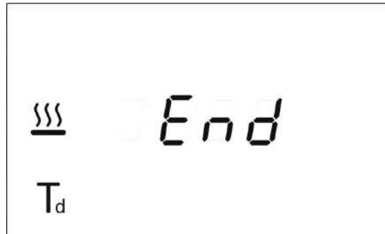
fig. 15 – Fin de cycle, affichage. Le message End indique que le lavage s'est terminé sans problèmes. En cas d'ouverture automatique : la porte s'ouvre automatiquement et 4 petits traits horizontaux s'affichent.
