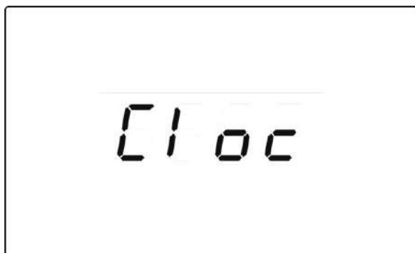
fig. 29 – Paramètres Cloc. La pression prolongée du bouton Marche/Arrêt permet d'accéder aux paramètres, dans ce cas identifiés comme C1, C2, etc. Le paramètre C1 indique l'année en cours ; C2 le mois, etc. Utiliser les boutons Sélection pour modifier le paramètre. Exercer une pression brève sur le bouton 5 - Fonctions pour passer d'un paramètre à l'autre. Appuyer sur le bouton Marche/Arrêt pour confirmer la modification.
