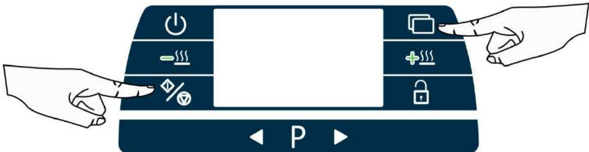
fig. 22 – Boutons pour la sélection du cycle de RÉINITIALISATION , pression prolongée combinée des boutons Marche/Arrêt + Fonctions.
