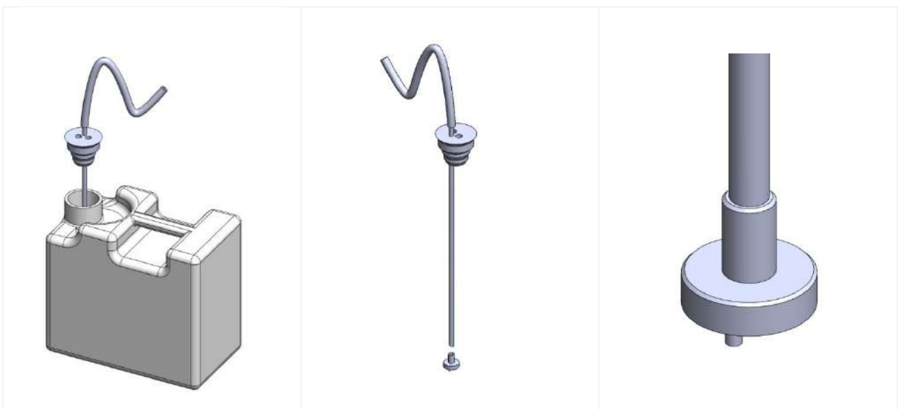
fig. 33 – Configuration STANDARD Tethys T60, aspiration des détergents. Positionnement du tuyau d'aspiration détergent dans le réservoir. Faire coïncider le bouchon en caoutchouc avec l'ouverture du réservoir pour bien positionner le tuyau. Le tuyau est équipé d'un filtre sur l'aspiration.
