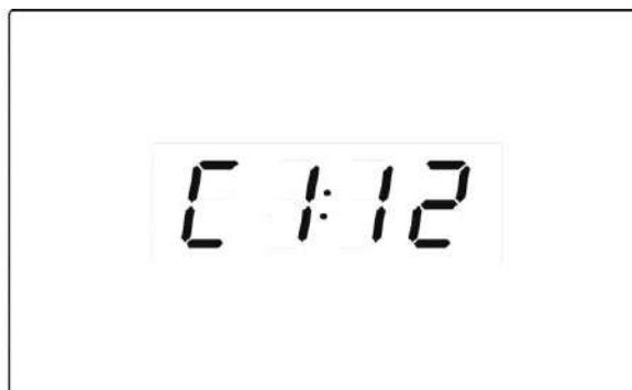
fig. 29 – Paramètres Cloc. La pression prolongée du bouton Marche/Arrêt permet d'accéder aux paramètres, dans ce cas identifiés comme C1, C2, etc. Le paramètre C1 indique l'année en cours ; C2 le mois, etc. Utiliser les boutons Sélection pour modifier le paramètre. Exercer une pression brève sur le bouton 5 - Fonctions pour passer d'un paramètre à l'autre. Appuyer sur le bouton Marche/Arrêt pour confirmer la modification.
